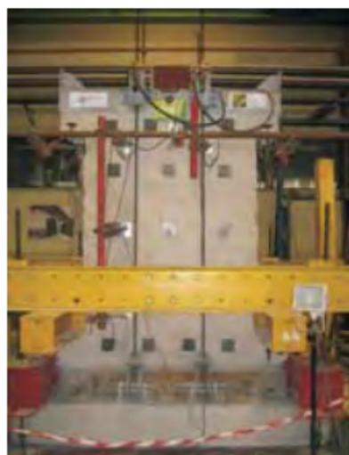
Fig.11 - Ensaio de sistema inovador de reforço com rede de carbono e com confinadores - Projeto RehabToolBox\*
