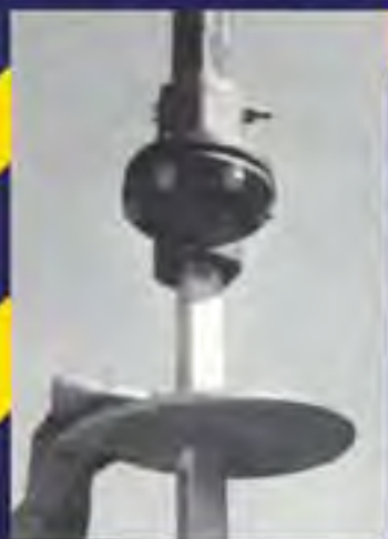
Uma cavilha roscada retém a ancoragem na ferramenta de instalação.
