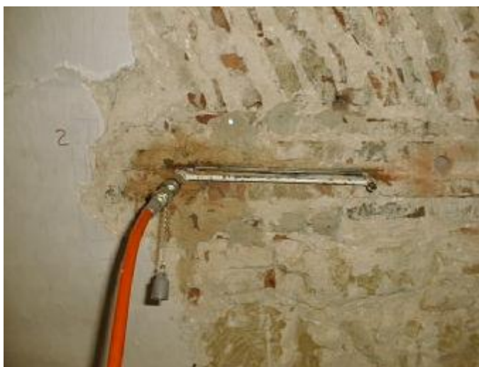
Figura 10 – Ensaio simples com macacos planos
